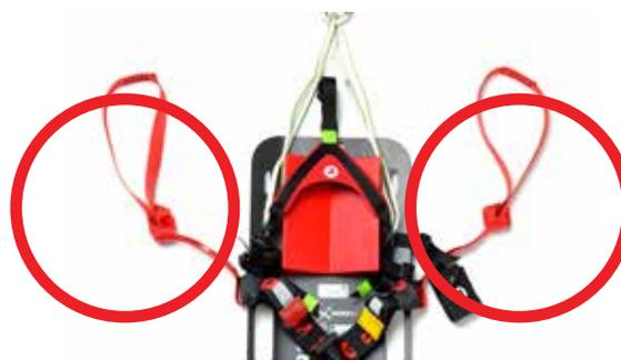
La **sospensione** per estricazioni o trasporti in ambienti complessi può essere fatta mediante accoppiamento del XT ed un anello omologato tessile come punto di ancoraggio (EN 566:2006) avente lunghezza minima di 120 cm e un connettore (EN 362).
