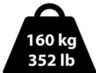
Non superare mai la capacità di carico dell'estrattore XT. Ispezionare l'estrattore se la capacità di carico è stata superata (consultare il paragrafo *Ispezione*, pagina 45).
