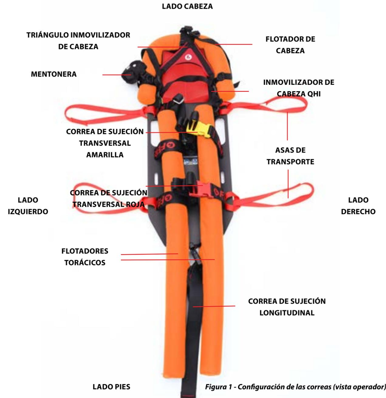
Figura 1 - Configuración de las correas (vista operador)
