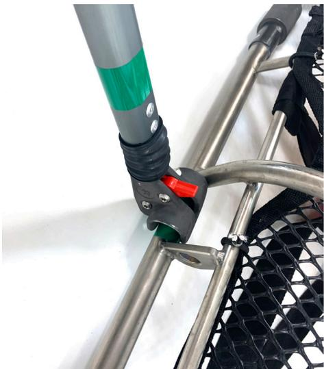
Verificare che i supporti delle ruote siano correttamente agganciati e possano ruotare agevolmente attorno al tubo.
