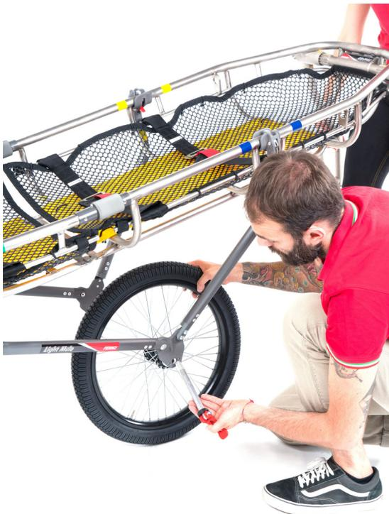
4. Avvitare saldamente il perno di bloccaggio della ruota e chiudere la leva di bloccaggio rossa in posizione.
