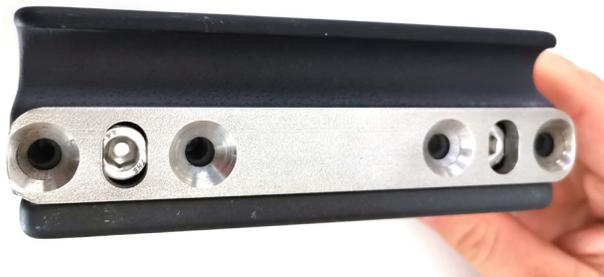
8. Appliquez 1 goutte de frein filet sur l'extrémité fileté des quatre vis à tête fraisée M6x16.
