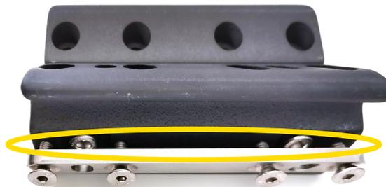
10. Desserrez les vis de réglage avec la clé Allen de 6 mm afin que les plaques de l'adaptateur Tirol Kit soient raccordées, mais qu'un jeu entre elles soit toujours possible.
