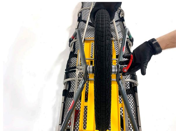
3. Den Sicherungsstift für das Rad festschrauben und den roten Verriegelungshebel schließen.
