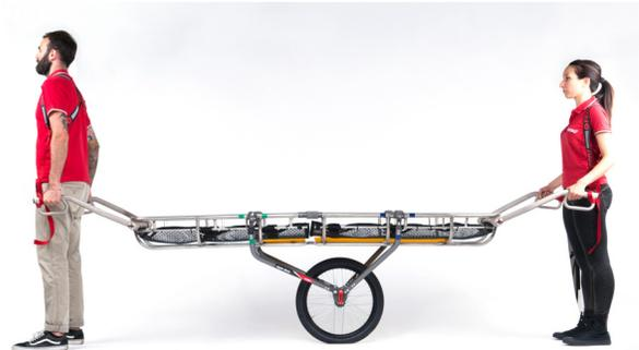
**Transportposition:** entspricht der Griffposition, die beim Transport am häufigsten von den Bedienern gewählt wird. Sie kann erzielt werden, indem die Griffe so montiert werden, dass die gelbe Linie mit dem Punkt mit der gezahnten oberen Markierung am Schaft übereinstimmt (gelbe Linie, falls der Schaft an der Innenseite montiert ist, bzw. rote Linie, falls er an der Außenseite der Trage montiert ist).
