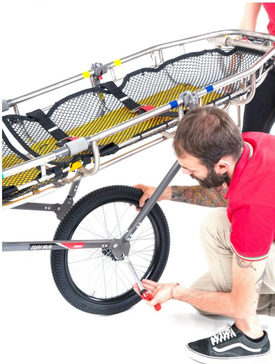
4. Den Sicherungsstift für das Rad festschrauben und den roten Verriegelungshebel schließen.
